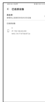
g) 可以在手机个人热点界面选择已连接设备, 出现“*”符号, 则表示连接成功。
