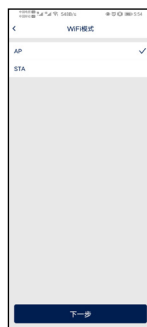
a) DVR 连接成功后, 进入 DVR 设置界面, 选择 WiFi 模式, 选择“STA”模式。
